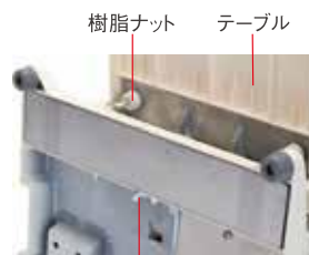
パーツカバーを固定している蝶ナットを緩めます
